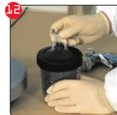
De niet verspoten lak kan tijdelijk bewaard worden door de binnenbeker af te sluiten met een dopje.
