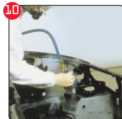
Met de vacuüm getrokken binnenbeker kan er nu vanuit iedere gewenste hoek gespoten worden.
