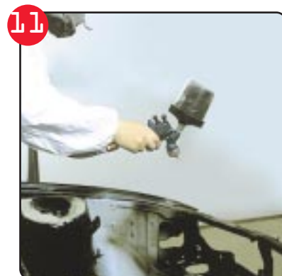
Wanneer er niet vanuit omgekeerde positie gespoten hoeft te worden kan er, zonder de binnenbeker vacuüm te zuigen, gespoten worden.
