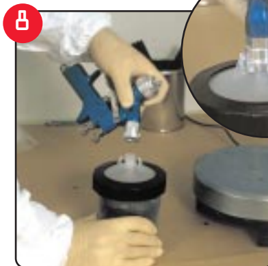
Het verfspuitpistool omgekeerd op de deksel plaatsen en met een klik de adapter vastzetten.
