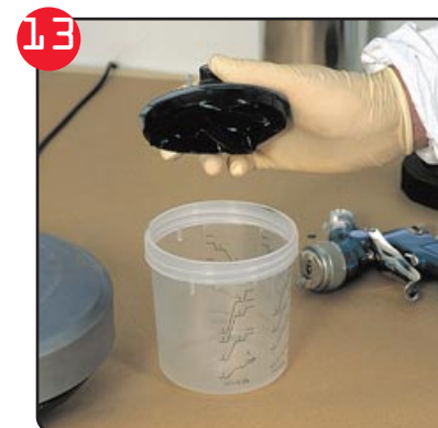
Wanneer het spuitwerk klaar is kan de binnenbeker inclusief deksel gemakkelijk afgevoerd worden.
